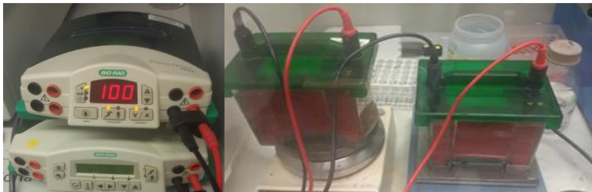
Figura 21. Electrotransferència en marxa.
