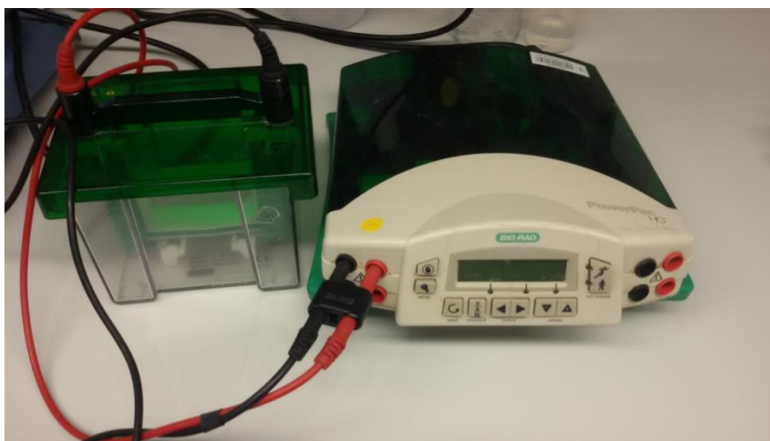
Figura 18. Muntatge de l'electroforesi. Hi apareixen la cubeta i la font, respectivament.
