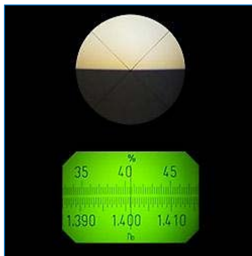
Figura 36. Exemple en què s'ha mesurat una concentració del 41% i un índex de refracció de 1,402.
