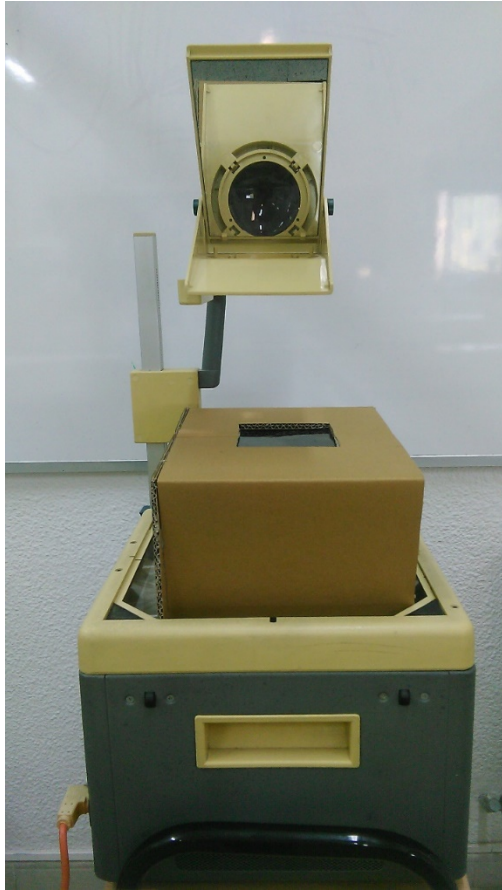
Figura 23. Vista general. El projecter és alhora la base del giny i la font de llum.
