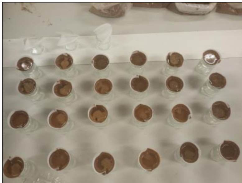
Figura 21. Mostres de sòl amb KCl filtrant-se. (Font pròpia)
