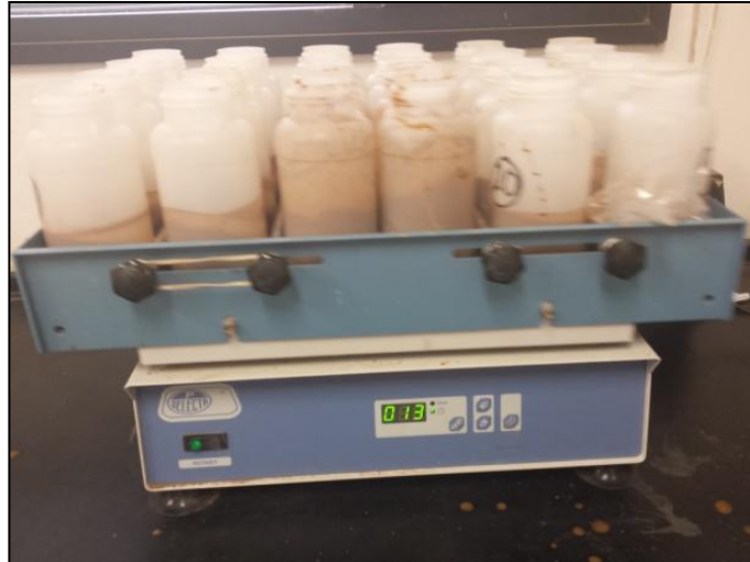
Figura 20. Pots a la sacsejadora per liquar el sòl per a poder-lo filtrar. (Font pròpia)
