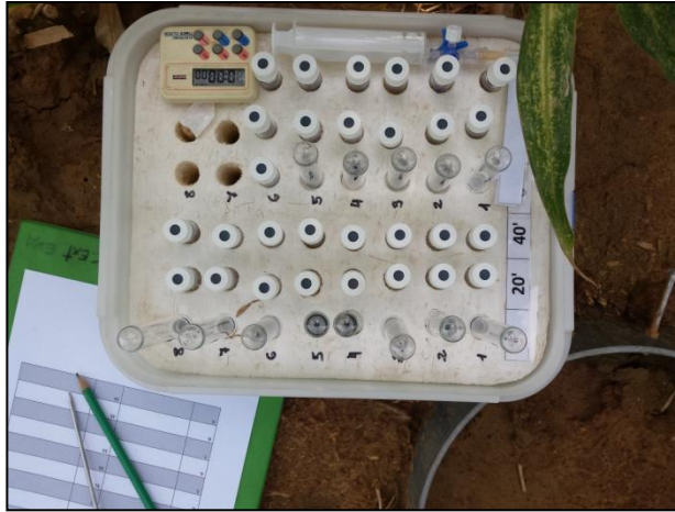
Figura 13. Càmera abans d'introduir-la a l'anella, vials i eines per a la temperatura. (Font pròpia)
