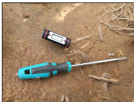
Figura 17. Termòmetre i tornavis per mesurar la temperatura del sòl. (Font pròpia)
