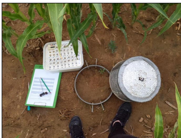
Figura 12. Càmera abans d'introduir-la a l'anella, vials i eines per a la temperatura. (Font pròpia)
