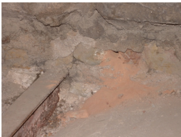
Perforació efectuada a la façana de Rambla Aragó. La pols dels primers 25cm és rogenca, corresponent a obra de fàbrica, i posteriorment, fins a travessar la totalitat del mur, és blanquinosa, corresponent a la pedra
