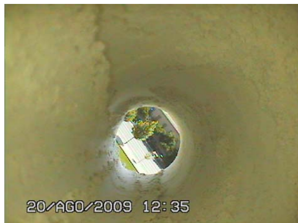
Vista del tram final de la perforació, amb material petri en tot el seu guix
