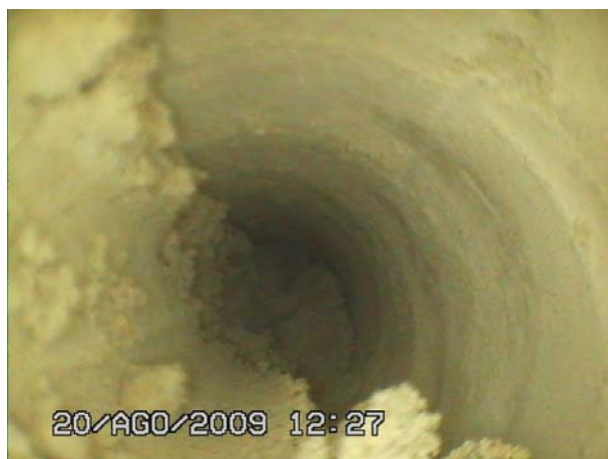
Vista amb l'endoscopi de la pedra, abans de finalitzar la perforació
