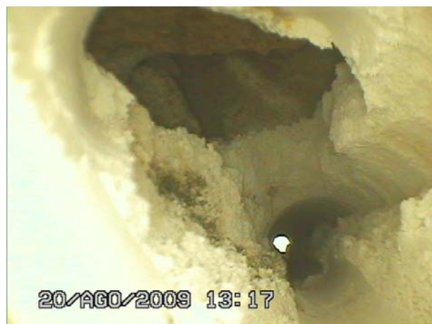
Secció C: Vista amb l'endoscopi de la perforació, a uns 30cm de profunditat
