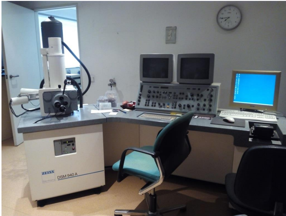
Microscopi d'Escombratge ZEISS DSM 940A (Germany) estudi dels electrons secundaris ES, Work Distance WD= 10 mm. Acceleració d'electrons 10 kV. Servei de Microscòpia Electrònica de la Universitat de Lleida, imatge pròpia.
